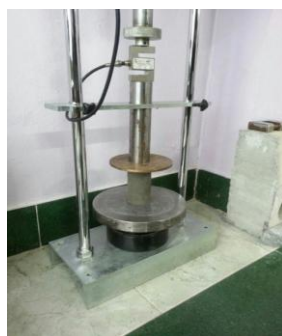
شکل ۱۰. بارگذاری تک‌محوری مغزه جدول ۵. نتایج آزمایش تک‌محوری مغزه‌ها
