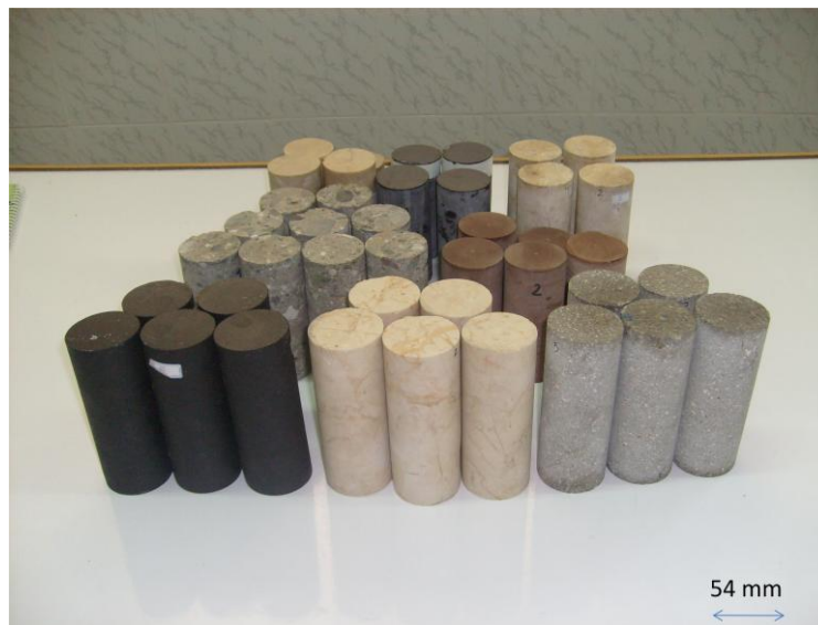
شکل ۶. مغزه‌های استوانه‌ای آماده‌سازی شده برای آزمایش اولتراسونیک
