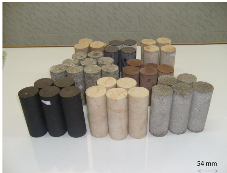
شکل ۶. مغزه‌های استوانه‌ای آماده‌سازی شده برای آزمایش اولتراسونیک
