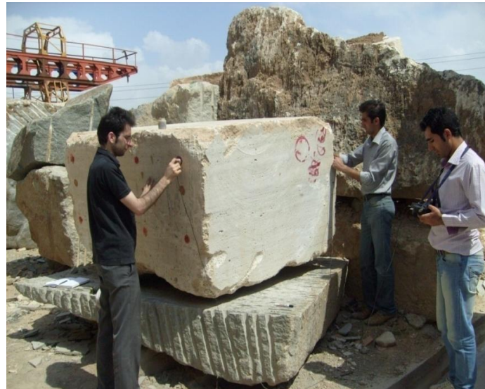
شکل ۴. انجام عملیات آزمایش بزرگ مقیاس سرعت عبور موج در نمونه تراورتن
