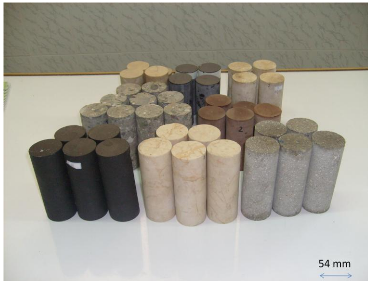
شکل ۶. مغزه‌های استوانه‌ای آماده‌سازی شده برای آزمایش اولتراسونیک
