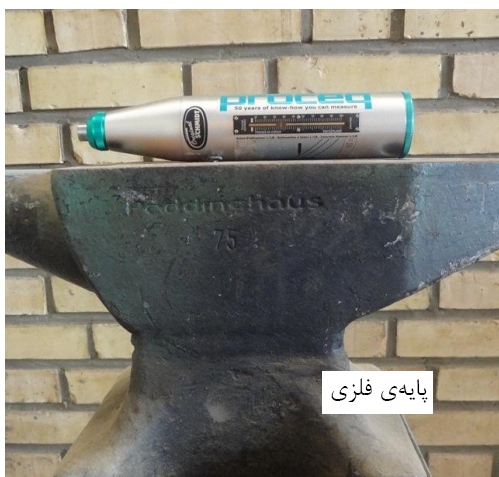
شکل ۲. چکش اشمیت به‌همراه پایه فلزی سنگین
