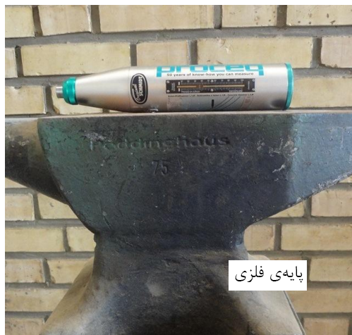
شکل ۲. چکش اشمیت به‌همراه پایه فلزی سنگین
