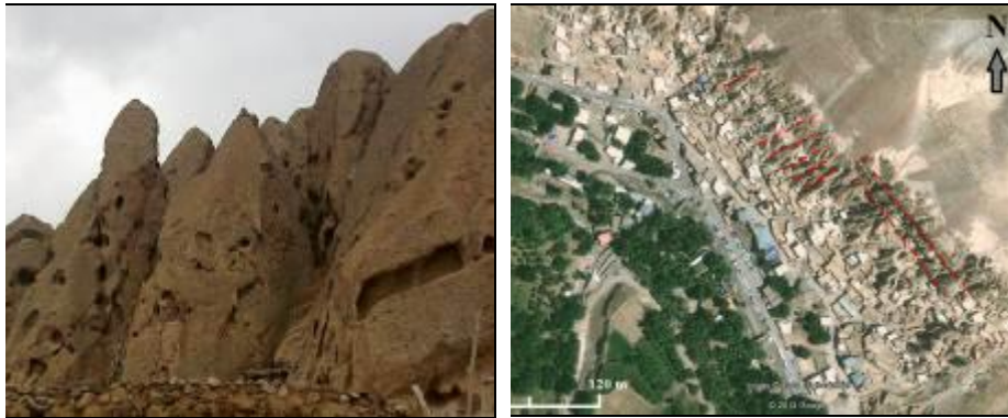
شکل ۶. عکس ماهواره‌ای روستای کندوان و روند شکستگی‌های اصلی در منطقه (راست) و تصویری از شکستگی‌ها موجود در سنگ (چپ)
