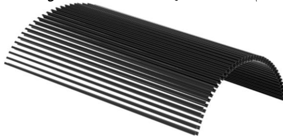
شکل ۸. مدل تحلیل به‌روش اجزاء محدود تیرآهن‌رانی
