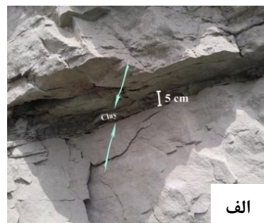
شکل ۷. الف) نمایی از شکستگی‌های سطحی پر شده با رس، ب) نمای نزدیک از مواد پرکننده درزه‌ها در جناح چپ که علاوه بر رس حاوی مقداری ژئیس با پوشش زنگ‌زدگی است
