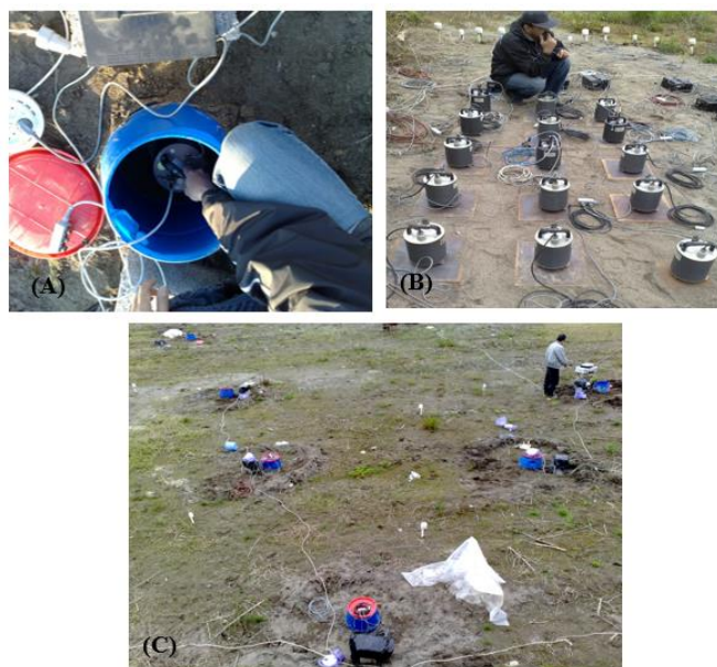
شکل ۴. (A) تصویری از استقرار و نحوه محافظت گیرنده در برابر بارندگی، (B) نحوه کالیبراسیون نسبی دستگاه‌های گیرنده در یک نقطه و (C) تصویری از گیرنده‌ها در حال ثبت امواج خردلرزه.
