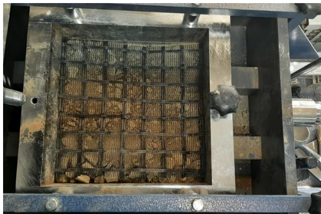
شکل ۱۷- استفاده از ژئوگرید دوسویه بر روی پسماندهای ساختمانی و قرار گرفتن آن در نزدیکی مرز برش
