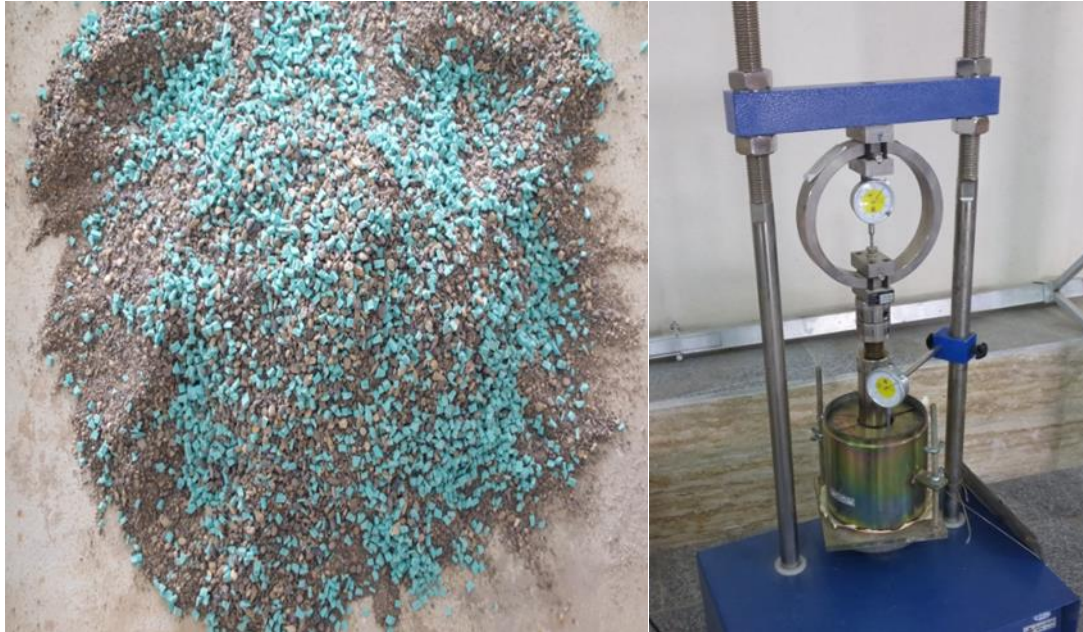
شکل ۷: نمونه آزمایش در حین بارگذاری
