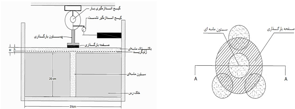
شکل ۴. شکل شماتیک جعبه و نمونه آزمایش.
