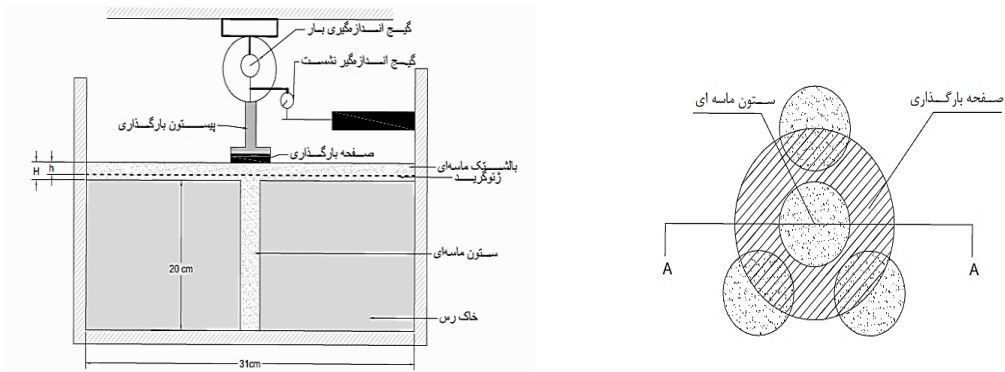
شکل ۴. شکل شماتیک جعبه و نمونه آزمایش.
