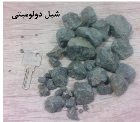
شکل ۱۰. شیل دولومیتی به عنوان کم دوام ترین و سنگ آهک به عنوان با دوام ترین نمونه بعد از چرخه ۱۵ آزمایش دوام وارفنگی در محلول اشباع نمک
