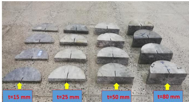
شکل ۴. نمونه‌های SCB از جنس سنگ مرمریت قروه با شعاع یکسان اما ضخامت‌های مختلف
