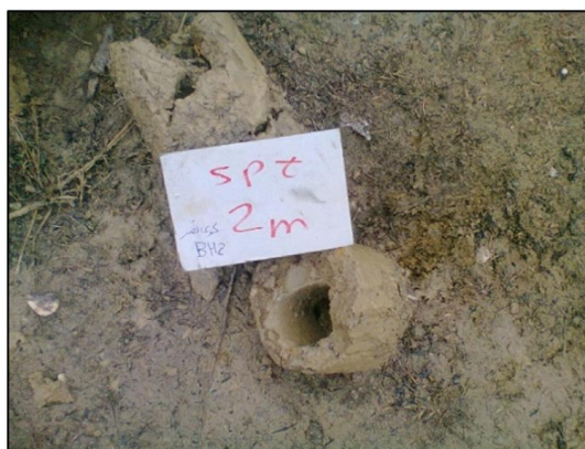
شکل ۵. حفره آزمایش نفوذ استاندارد در داخل مغزه نمونه (گمانه B2)
