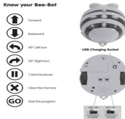
شکل ۱ - ربات زنبور (Bee bot) و اجزاء آن
