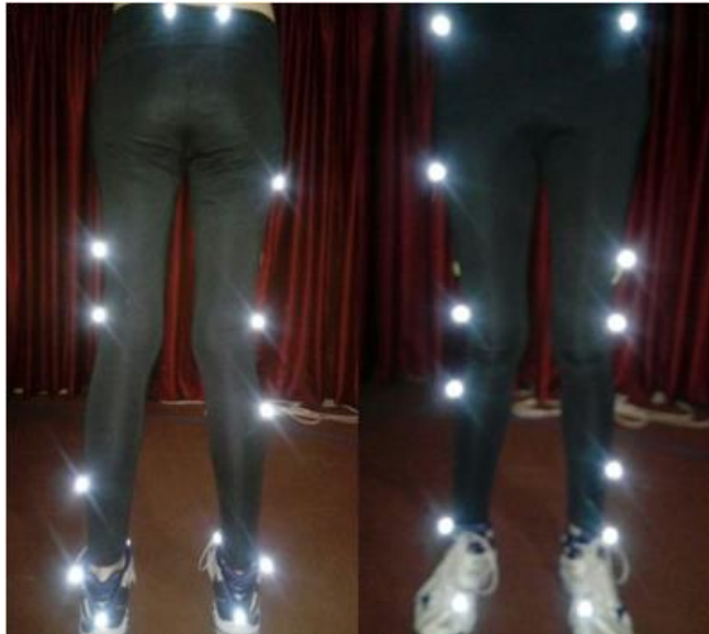
شکل ۱. لندمارک‌های اندام تحتانی در مدل پلاگین گیت
