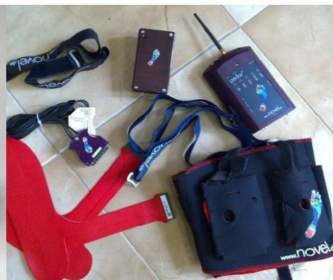
تصویر ۱. دستگاه اندازه‌گیری توزیع فشار کف پایی
