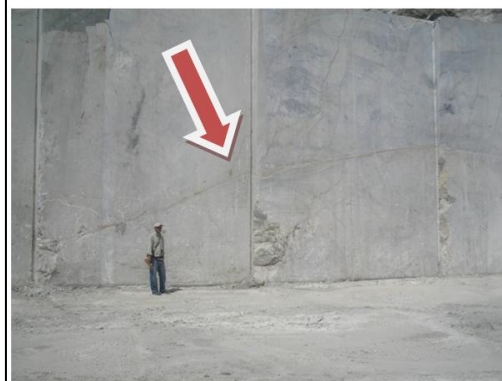
شکل ۱۴. نمایی از درز J5 که با پیکان قرمز مشخص شده است شکل ۱۵. نمایش صفحه درز J5 در محیط نرم‌افزار DIPS5.1 (دید به سمت جنوب باختر)
