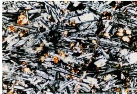
شکل ۱۳- بازالت تا حدی دگرسان شده با بافت پیلو تاکسیتی (بزرگ‌نمایی 25\times ، xpl).
