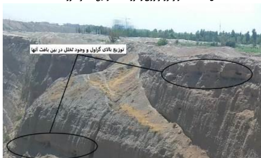
شکل ۱۶: توزیع بالای گراول، عدم جوش زدگی و وجود تخلخل که بیانگر هدایت خوب آبهای زیرزمینی می‌باشد
