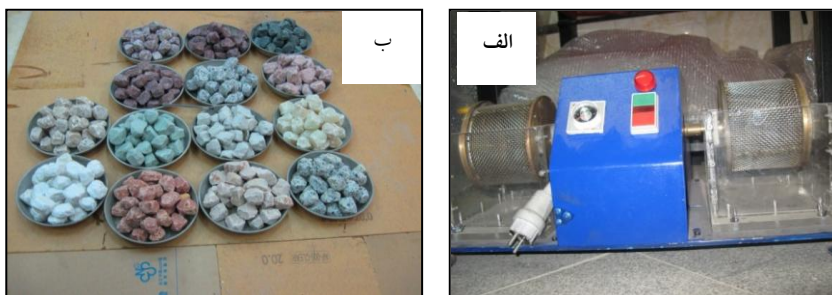
شکل ۱. الف) دستگاه آزمایش دوام استاندارد [۶]، ب) تعدادی از نمونه‌های تهیه شده برای آزمایش
