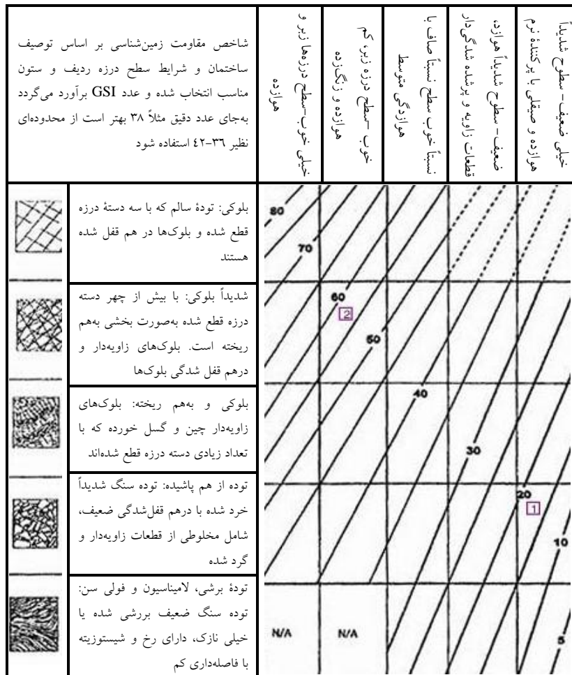
شکل ۸. طبقه‌بندی GSI توده‌های سنگی منطقه
