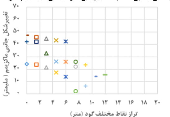
شکل ۹. تغییر شکل جانبی حداکثر برای نقاط داخل گود پس از اتمام عملیات حفاری
