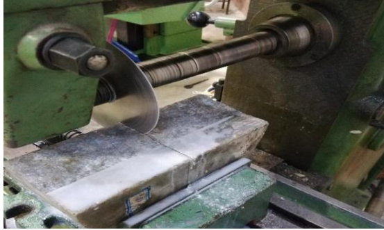
شکل ۳. نحوه ایجاد ترک در قطعات نیم‌دیسک
