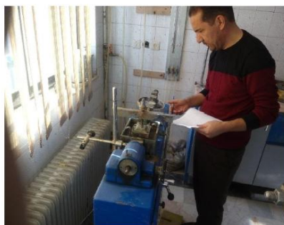
شکل ۱۱. الف) یکی از نمونه‌های آماده‌سازی شده برای آزمایش مقاومت فشاری تک‌محوری، ب) دستگاه آزمایش مقاومت فشاری تک‌محوری
