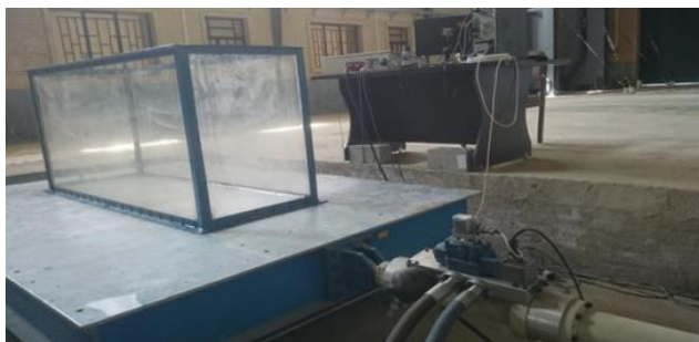
شکل ۱. محفظه مدل روی میز لرزه
