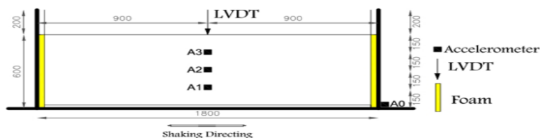
شکل ۲. شکل شماتیک نمونه‌های آزمایش همراه با ابزاربندی
