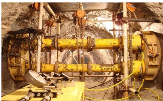
شکل ۵. نمایی از آزمون بارگذاری صفحه‌ای به صورت افقی در گالری RG3 [۳۹]
