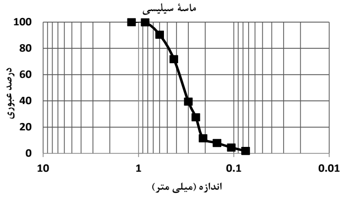
شکل ۶. دانه بندی ماسه آزمایش شده
