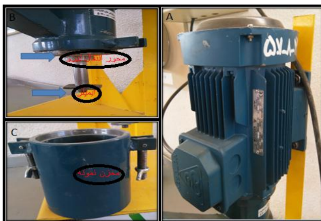
شکل ۱. بخش‌های اصلی دستگاه LCPC (الف) الکتروموتور تامین کننده نیروی محرکه دستگاه، (ب) محور انتقال نیرو و تیغه فلزی، (ج) مخزن نمونه
