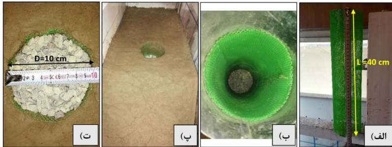
شکل ۷. مراحل اجرای ستون سنگی مسلح: الف) آماده‌سازی شبکه مسلح‌کننده ستون سنگی، ب) قرار دادن شبکه آماده شده در داخل استوانه فلزی فرو شده در خاک و ریختن و کوبیدن مصالح ستون سنگی در لایه‌های ۵ سانتی‌متری، پ) ستون اجرا شده در لایه یکی مانده به آخر، ت) ستون سنگی تکمیل شده و کنترل قطر ستون اجرا شده
