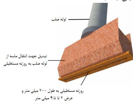
شکل ۴. تبدیل جهت انتقال ماسه از لوله صلب به روزنه مستطیلی
