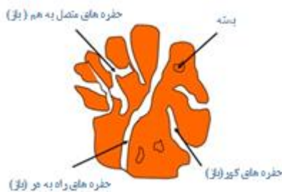
شکل ۲. نوع تخلخل‌ها بر اساس شکل و موقعیت [۲]
