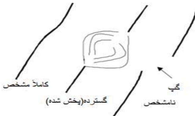
شکل ۳. رده‌بندی گسل‌ها براساس تظاهر سطحی [۲۴]
