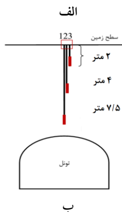
شکل ۱۰. الف) موقعیت نصب کشیدگی سنج‌ها در مسیر تونل، ب) مقطع عرضی نصب
