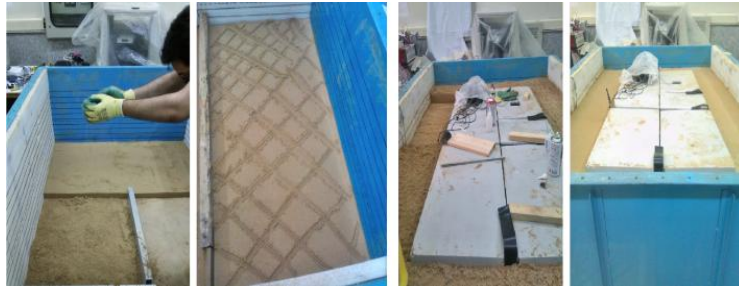
شکل ۹. خاک‌ریزی جعبه آزمایش
