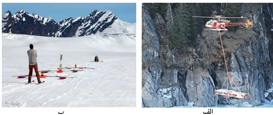
شکل ۱. نمایش سیستم GPR با ارائه مثالی از برداشت پروفیلی به‌صورت هوایی (الف) و زمینی (ب) روی برف و یخ
