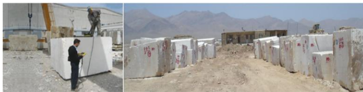
شکل ۹. الف) نمایی از بلوک‌های استخراجی تراورتن مجتمع معدنی حاجی‌آباد محلات و ب) ارزیابی آن‌ها با روش GPR
