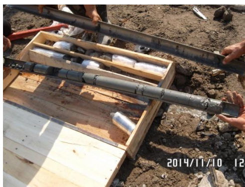
شکل ۸. جعبه نمونه محتوی مغزه‌های شکل ۹. مته سه جداره مغزه‌گیری به همراه محفظه به‌دست‌آمده از ستون L6-1 تا عمق ۶ متر
