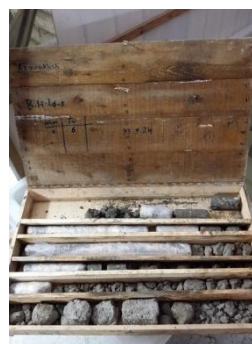
شکل ۸. جعبه نمونه محتوی مغزه‌های شکل ۹. مته سه جداره مغزه‌گیری به همراه محفظه به‌دست‌آمده از ستون L6-1 تا عمق ۶ متر
