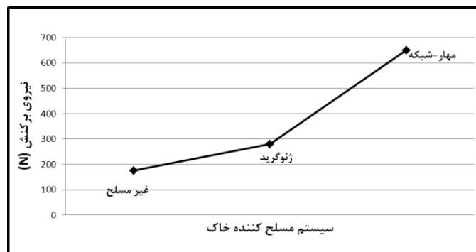
شکل ۱۰. تغییرات مقاومت برخاست حداکثر لوله مدفون با نوع سیستم مسلح کننده در ماسه خشک و لایه مسلح کننده در زیر لوله ( b=5D , h/D=2 , N=1 , D=50\text{mm} )
