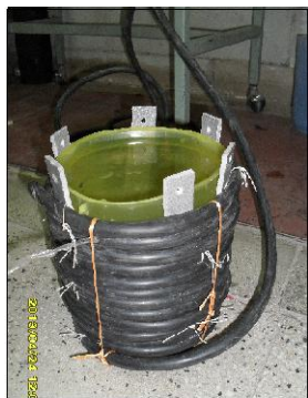
شکل ۳. سیم‌پیچ ایجاد شده برای تولید جریان الکترومغناطیس
