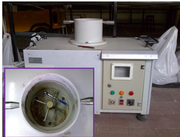
شکل ۷. دستگاه سایش اصلاح شده با سنجش‌گر پیچ آهنی به جای دیسک (دستگاه FUAT)
