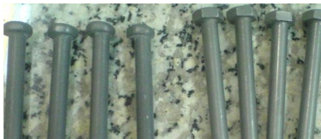
شکل ۸. پیچ‌های سنجش‌گر قبل از آزمایش (راست) و بعد از بیش از حدود ۲۰ آزمایش (چپ) جدول ۱. تفاوت جزئیات روش‌های مختلف اندازه‌گیری سایش خاک
