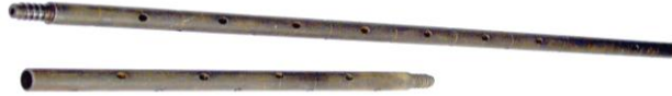
شکل ۴. نمونه‌هایی از میله‌های رابط سوراخ‌دار که با تزریق بتونیت از طریق سوراخ‌ها می‌توان اصطکاک را کاهش داد
