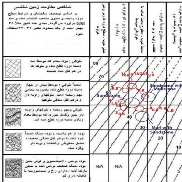
شکل ۱۱. نمودار برآورد شاخص مقاومت زمین شناسی (GSI) به همراه جای گاه قطعات مختلف هر جناح. دایره های بزرگ آبی رنگ جای گاه کلی توده سنگ های موجود در کل مخزن به تفکیک
